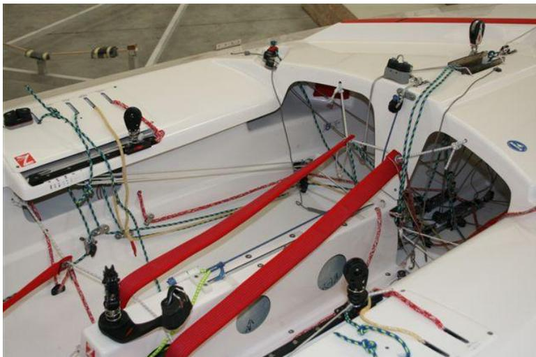
double réglage de drisse de foc: le réglage habituel avec palan au centre du bateau et un deuxième réglage fin qui revient sur chaque bord. Pour le mât, pas de levier, mais un palan avant et un palan arrière. L'ajustement du margouillet de foc est disponible avant / arrière et par poulie volante pour la hauteur. Les taquets du plat bord sont protégés. Il n'y a pas de plaque de dérive à l'avant du puits, elle
