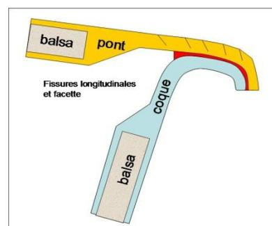
La réparation consiste à restituer la cohésion de la peau extérieure qui travaille en allongement. La zone fissurée est poncée sur 1 à 2 mm en débordant et en finissant en biais puis on stratifie en une seule fois trois couches alternées bien saturées, bien ébullées :
